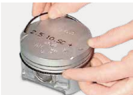
2. Die untere und die obere Lamelle wird um 120° stoßverdrehung eingesetzt.
