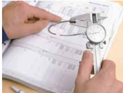
Prüfung mit Messschieber mit Rundskala, Genauigkeit 0,01 mm KS Art.-Nr. 50 009 814
