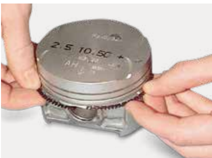
1. Die Expanderfeder wird in die Nut eingepasst.
