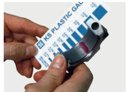
Control del cojinete de deslizamiento con la tira “KS Plastic Gauge”
