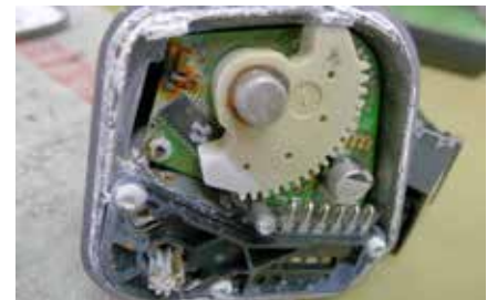
Blick in das Innere einer beschädigten Regelklappe
