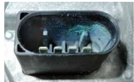
Einbaustecker mit Korrosionsspuren
