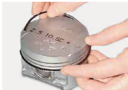
2. Нижняя пластинка вставляется смещенной на 120°.
