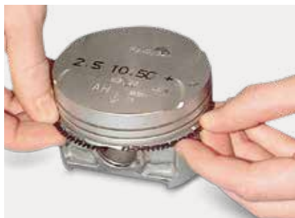
1. Пружина-расширитель вставляется в канавку.
