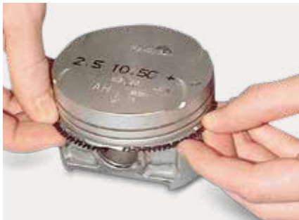
1. Placer le ressort expanseur dans la gorge.
