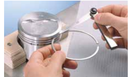
Mesure des gorges de segment de piston avec un calibre d'épaisseur. N° d'article KS 50 009 824
