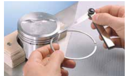
Medición de las ranuras del segmento con calibre de espesores. N.º de artículo KS 50 009 824
