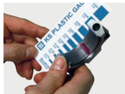
Проверка подшипника скольжения с помощью «KS Plastic Gauge»
