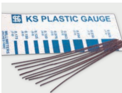
« Jauge KS en plastique » – Bande de calibrage pour coussinets (n° d'article 50 009 880)
