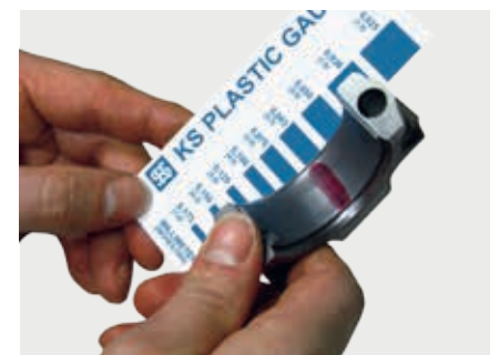
Prüfung des Gleitlagers mit „KS Plastic Gauge“
