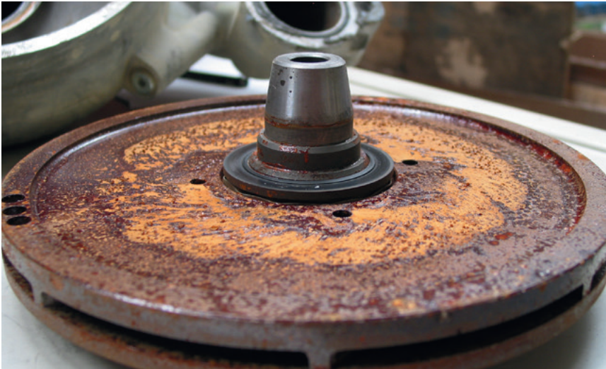
Korozyon oluşmuş kanatlı çark
