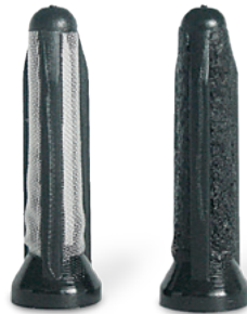
Prefiltru E1F: stânga nou, dreapta colmatat
