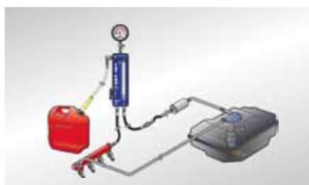
Przykład: układ podczas pomiarów w układzie paliwowym ze strumieniem wstecznym
