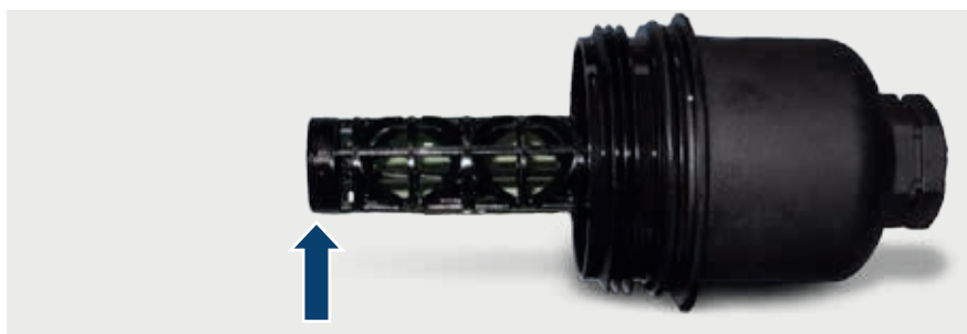
Rys. 2: Pęknięcie plastikowej rurki, zawór odpływowy nie jest zamknięty
