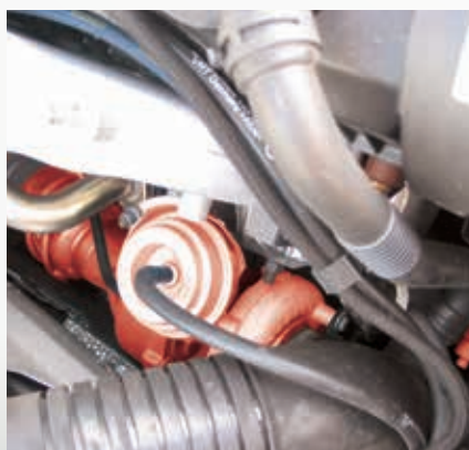
Elektropneumatyczny zawór przetwornika ciśnienia (EPW) i turbodoładowania w Audi A4 TDI (zaznaczony).
