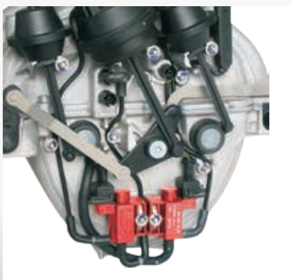
Elektropneumatyczny zawór przetaczający (EUV) na rurze ssącej w Mercedesie Klasy C (zaznaczony).
