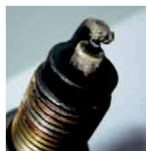
Typisches Schadensbild bei Autogasbetrieb: eine überhitzte Zündkerze, da bei Autogasbetrieb deutlich mehr Wärme entsteht. Tipp: Setzen Sie eine Zündkerze mit einem Wärmewert ein, der um 1 niedriger ist.
