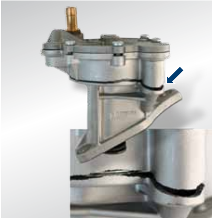
Res. 1: Pompa gövdesinde kırıklık
