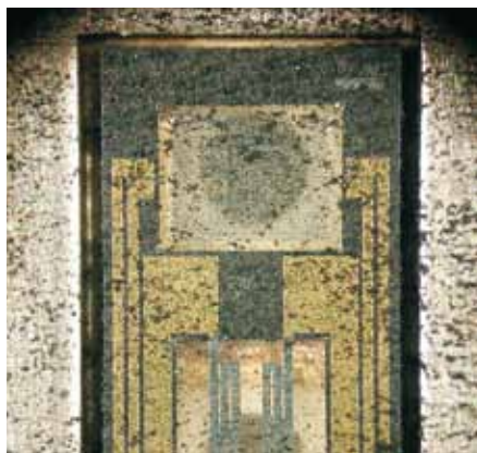
Sól i brud mogą uszkodzić czujnik przepływu powietrza – co najmniej jednak powodują nieprawidłowe pomiaru, co z kolei może wpływać na EGR.
