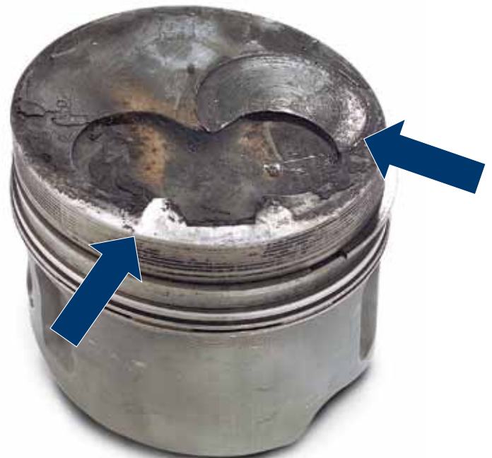
Rys. 4: Ślady powstałe na skutek przegrzania silnika
