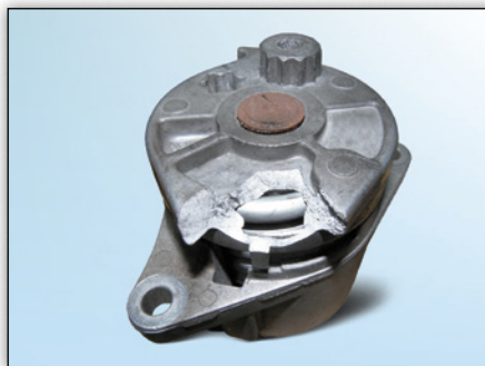
Bild 3: Beispiel eines gebrochenen Spannarmes 533 0017 10
