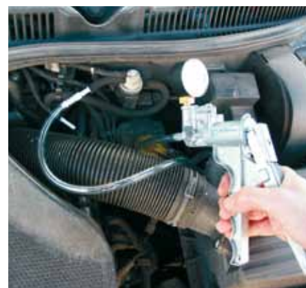
Ať již jde o pneumatické ventily AGR nebo zde EPW: pomocí ručního podtlakového čerpadla je možno snadno zkontrolovat jejich funkci.
