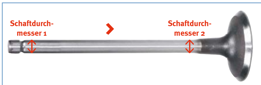
Abb. 1 Beim konischen Ventilschaft ist Schaftdurchmesser 1 (Schaftende) größer als Schaftdurchmesser 2 (beim Ventilteller)
