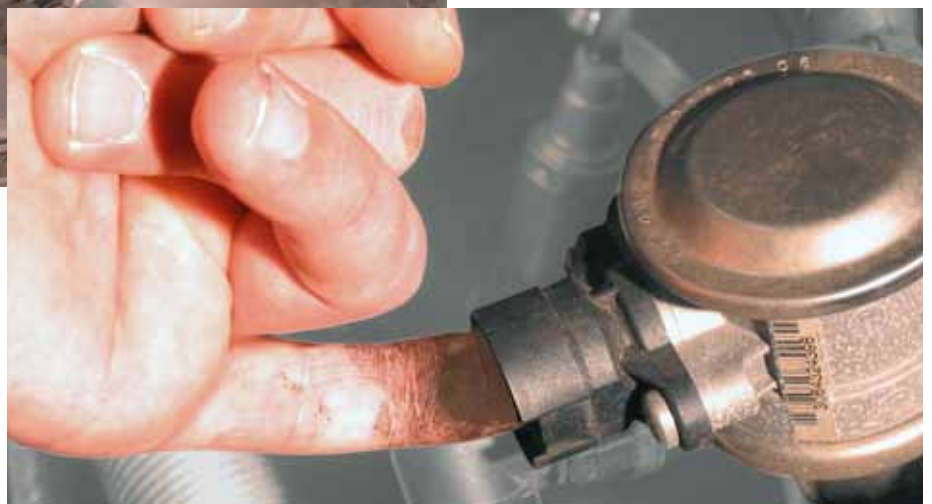
Verificarea rapidă a supapei de aer secundar la BMW 520i (evidențiat)
