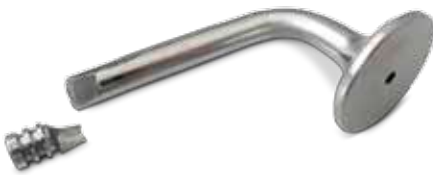
Abb. 1 Gewaltbruch am Einstich
