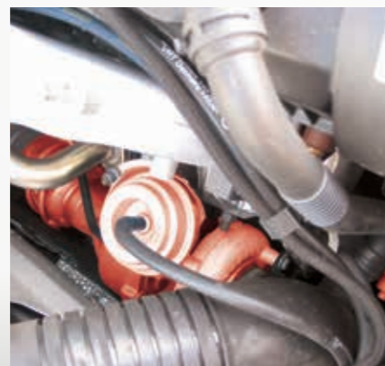
Convertisseur de pression électropneumatique (EPW) et turbocompresseur d'une Audi A4 TDI (accentuée).
