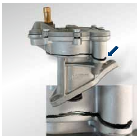
Ill. 1: brud i pumpehuset
