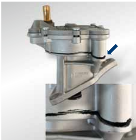
Abb. 1: Bruch im Pumpengehäuse
