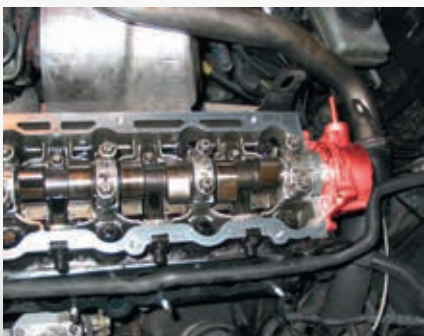
Stand der Technik sind Einflügel-Vakuumpumpen, die von der Nockenwelle angetrieben werden.
