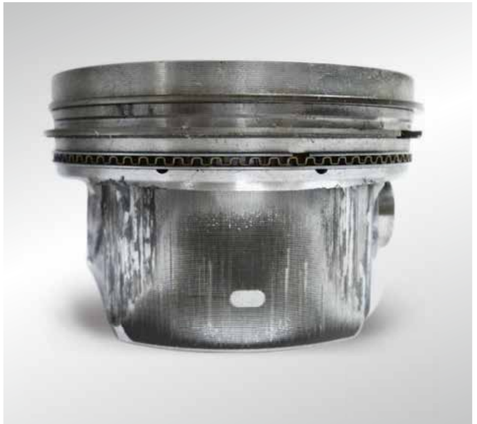
Foto 06: Pistão 97 539 com engripamento a 45° do cubo do pino
