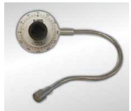
Figura 02: Aperto do cabeçote com torquímetro Figura 03: Goniômetro (aperto em graus)
