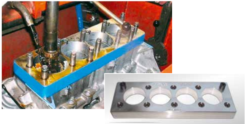
Figura 04: Brunimento do bloco com placa torquçada.
