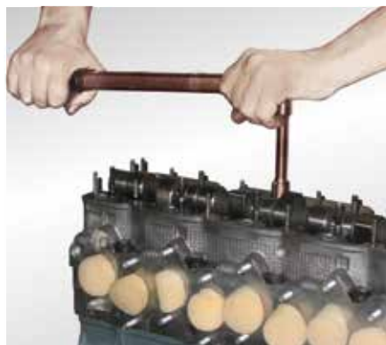
Figura 02: Aperto do cabeçote com torquímetro Figura 03: Goniômetro (aperto em graus)
