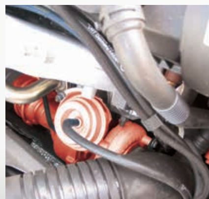
Convertitore di pressione elettropneumatico e turbocompressore nell'Audi A4 TDI (evidenziato).
