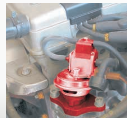
Convertitore di pressione elettrico nella valvola EGR nell'Opel Astra (evidenziato).
