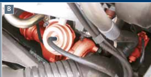
B Transdutor de pressão electro-pneumático (EPW) e turbocompressor no Audi A4 TDI (em destaque).
