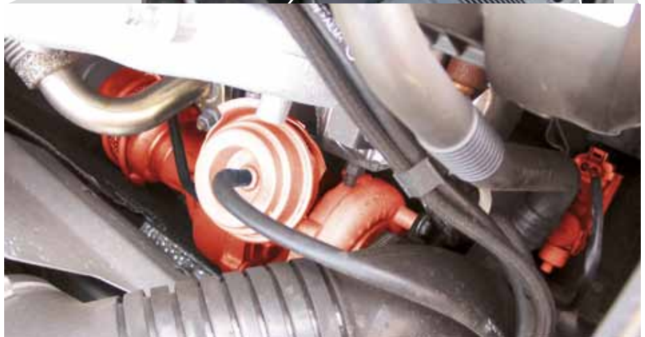
Convertidor electro-neumático de la presión y cargadores VTG (resaltado en rojo) en el Audi A4 TDI
