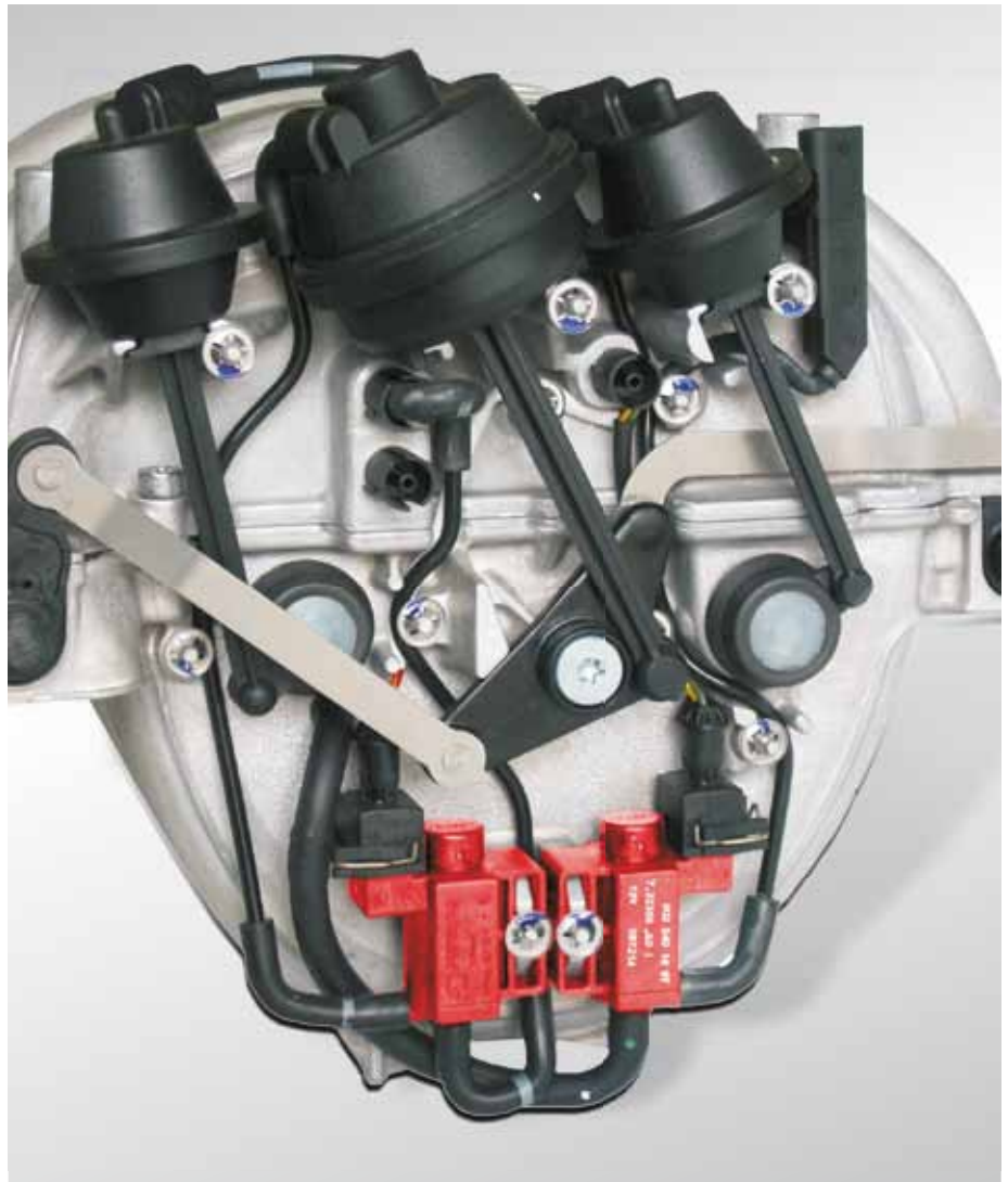
Ejemplo de aplicación: tubo de aspiración con válvulas electro-magnéticas (resaltadas en rojo) en el Mercedes de la clase C
