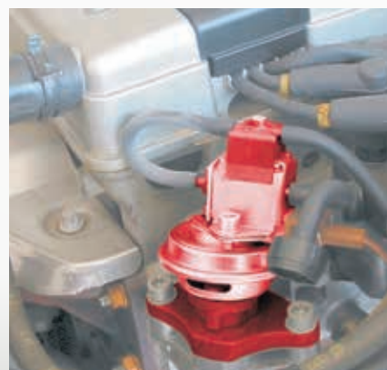
Transductor eléctrico (EDW) en una válvula EGR de un Opel Astra (destacado).
