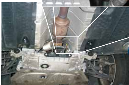
Válvula de desvio de ar no VW EOS TFSI (destacada a vermelho)
