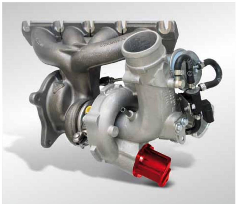
Válvula de desvio de ar (destacada) no turbocompressor de um Audi A3 2.0 TFSI
