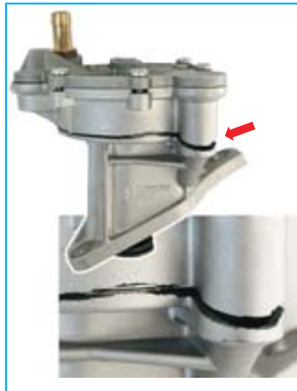
Rys. 1 Uszkodzenie obudowy pompy
