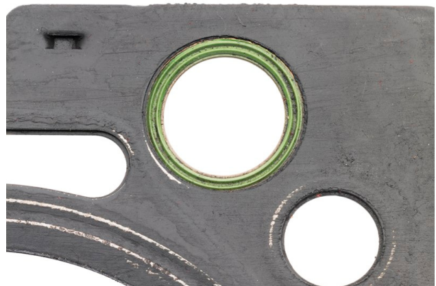
Bild 3 Unsauberkeiten durch das chemische Dichtmittel am äußeren Rand des grünen, elastomeren Dichtelements und auf der Dichtfläche
