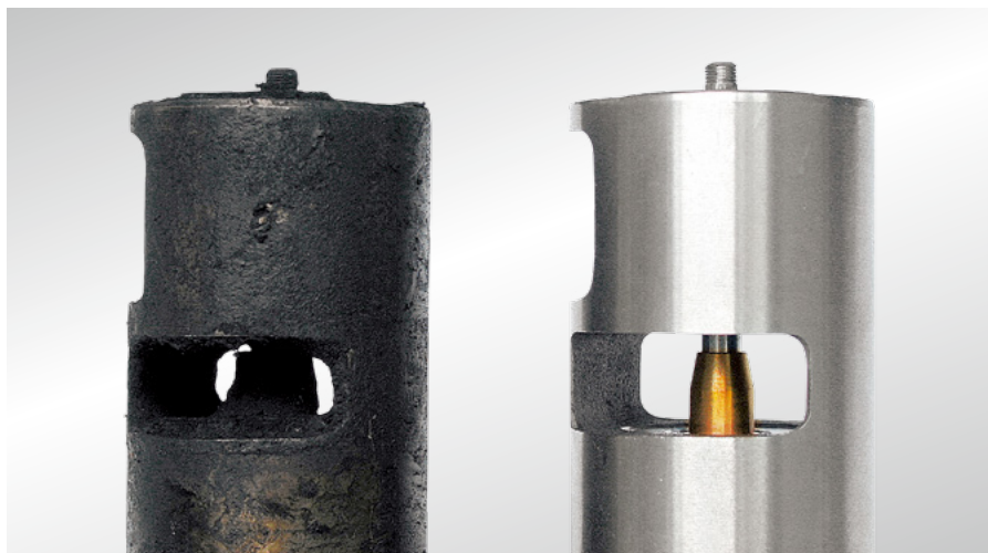
Rys. 38 Zawór recyrkulacji spalin (Diesel) z mocnymi nalotami i nowy
