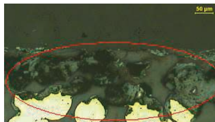
Uszkodzenie wskutek działania czynników chemicznych
