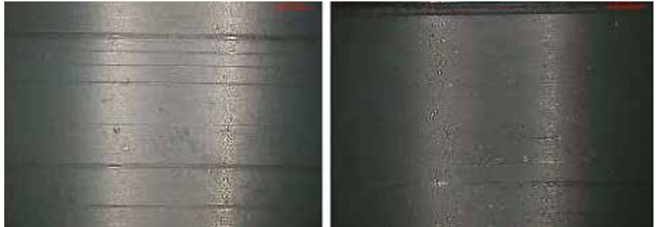
Abb. 1: P2-Gleitlager, Riefen in der Lauffläche
