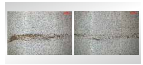
Schaden durch Erosion in der Einlaufschicht P1-Gleitlager
