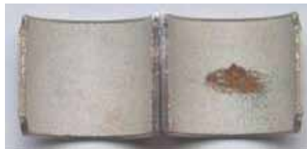
Örtlicher Schaden durch Kavitation
