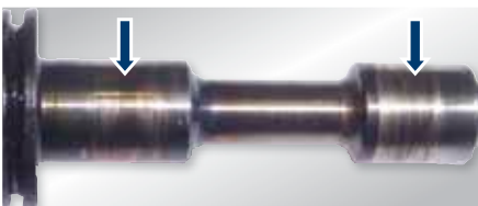
Abb. 3 Durch Öl-mangel beschädigte Turboladerwelle
