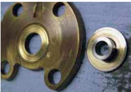
Abb. 2 Beschädigung am Axiallager
