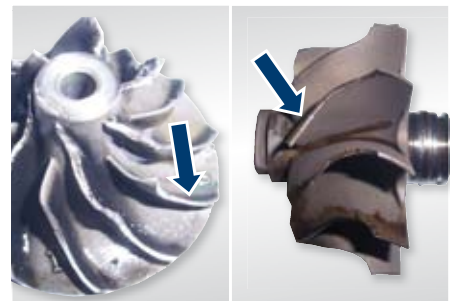
Abb. 4 Verdichterrad (links) und Turbinenrad (rechts) durch Anlaufen an den Gehäusen symmetrisch beschädigt
