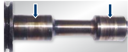
Abb. 3 Durch Ölsmangel beschädigte Turboladerwelle
