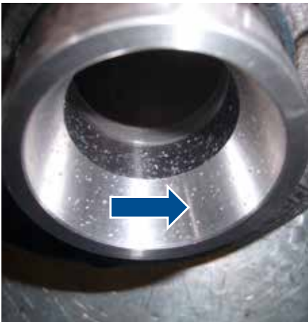
Abb. 1: Einschlagspuren des Fremdkörpers sind im Ansaugtrichter erkennbar
