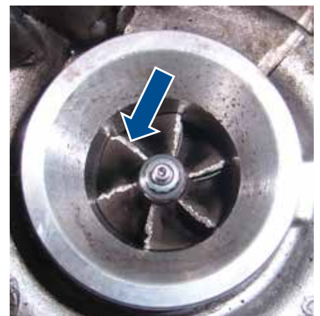
Abb. 2-4: Die Gaseintrittskanten des Verdichterrades wurden durch einen Fremdkörper im Ansaugtrakt beschädigt
