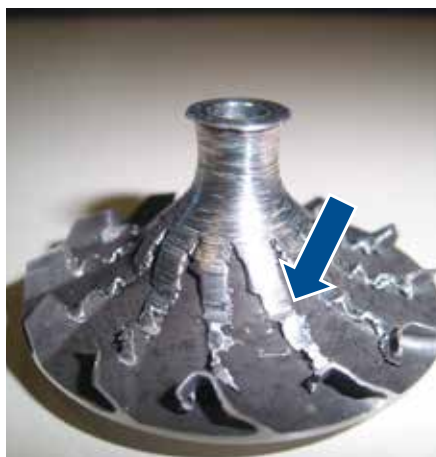
Abb. 2-4: Die Gaseintrittskanten des Verdichterrades wurden durch einen Fremdkörper im Ansaugtrakt beschädigt
