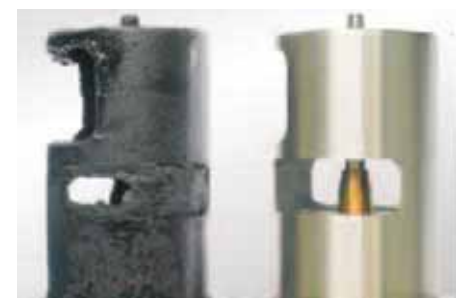
Abb. 2 Verrußtes AGR-Ventil und Neuzustand
