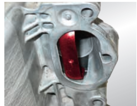
Clapet tumbler (en rouge) pour le mode charge stratifiée
