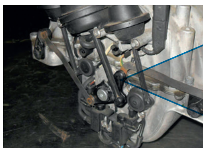
Constatation des dégâts : rupture au niveau de la tringlerie de commande des vitesses
