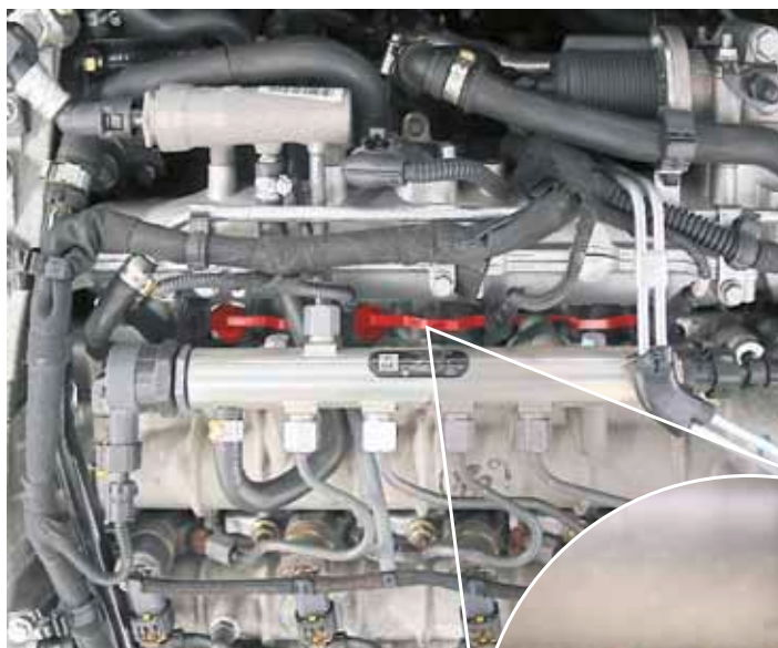
Timoneria de cuplare la tubul de aspirare la Opel Vectra (sus scoasă în evidență cu roșu și schiță detaliată)
