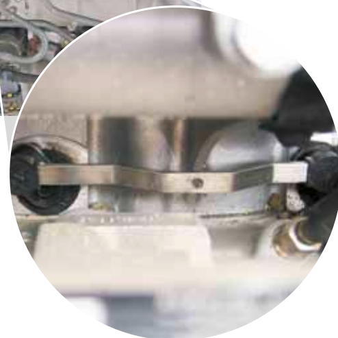
Timoneria de cuplare la tubul de aspirare la Opel Vectra (sus scoasă în evidență cu roșu și schiță detaliată)
