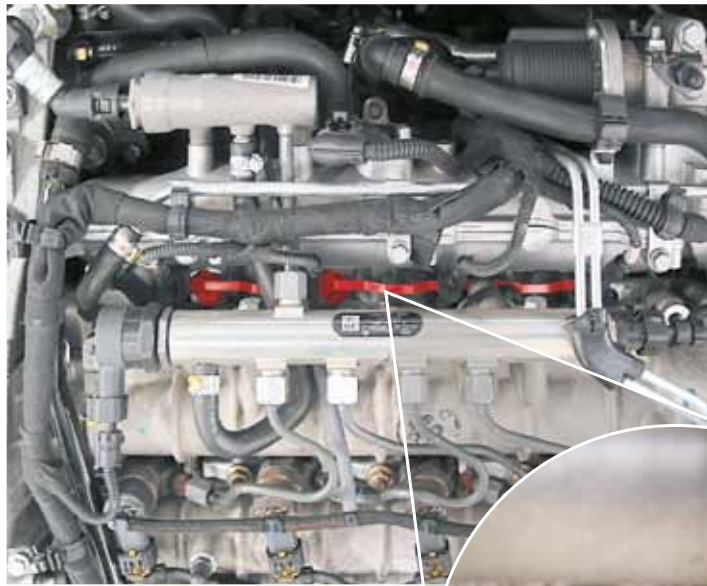
Varillas de conmutación en el Opel Vectra (arriba resaltado en rojo y vista de detalle)
