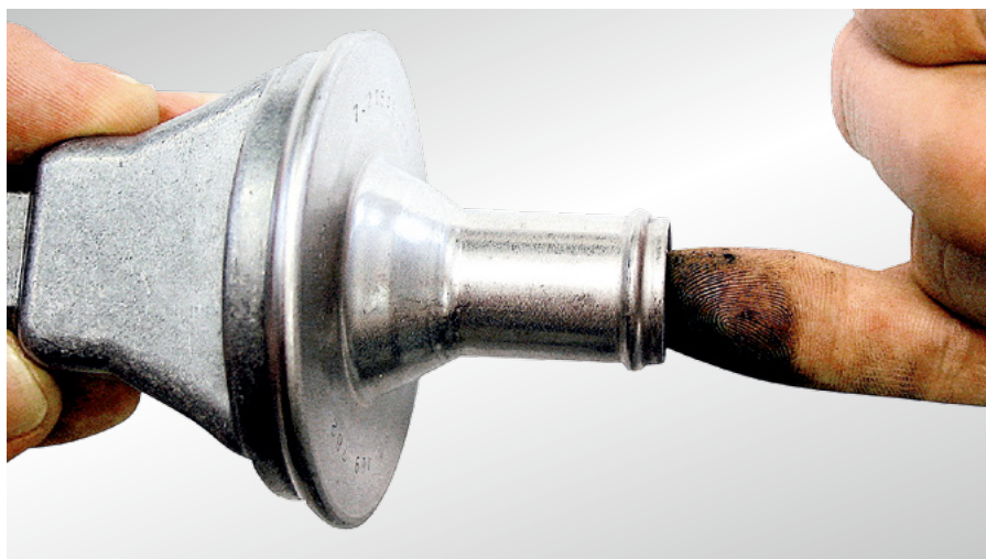
Rys. 32 Prosta kontrola zaworu zwrotnego
