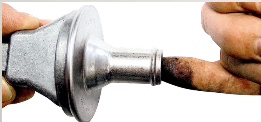
Abb. 32 Einfache Prüfung des Rückschlagventils
