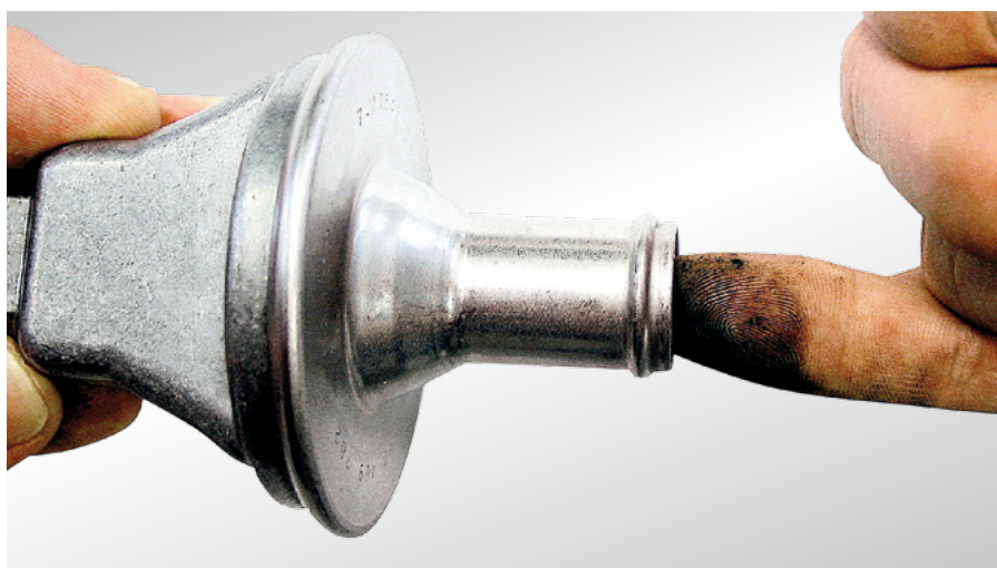
Fig. 32 Contrôle simple du clapet anti-retour
